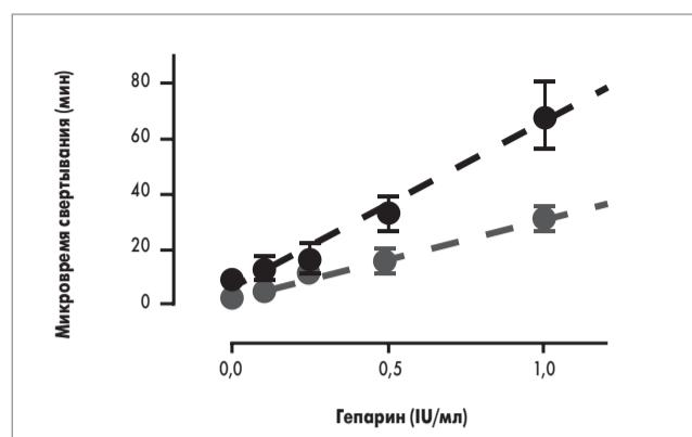
**Рис. 6. График эмпирической валидации микровремени свертывания крови, полученный из феноменологической аналитической модели путем варьирования концентрации гепарина в диапазоне 0-1 IU/ml перфузии крови при сдвиге градиентов скорости 1,225 и 4,375  $\text{с}^{-1} \text{ мм}^{-1}$  (черные и серые кружки соответственно)**
