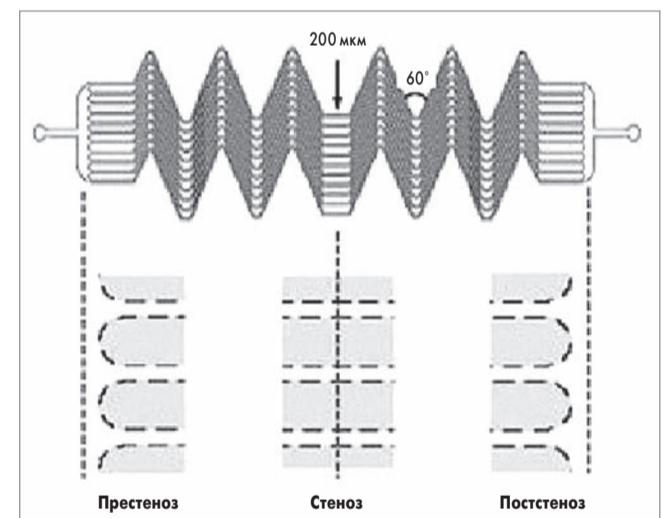
Рис. 1. Схема устройства с областями микроканалов (престеноз, стеноз, постстеноз). Центральная стенозированная область содержит 12 параллельных каналов (ширина 200 мкм, высота 75 мкм). Каналы (престеноз и постстеноз) многократно повернуты несколько раз под углом 60°
