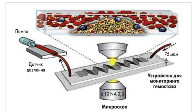
Рис. 2. Схема устройства для мониторинга гемостаза. Цельная кровь подается с помощью шприца через датчик давления, который подключен к устройству и используется для определения времени свертывания крови. Возможно применение флуоресцентного микроскопа для мониторинга процесса образования тромба
